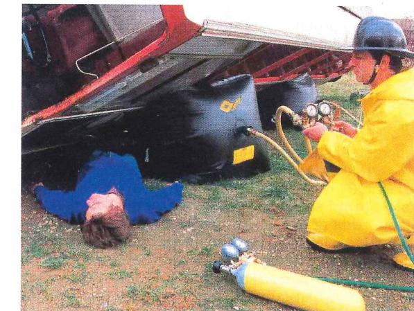
Slika 29: Rad niskotlačnim zračnim jastukom
