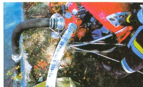
Slika 2.1. Usisne i tlačne cijevi priključene na motornu pumpu
