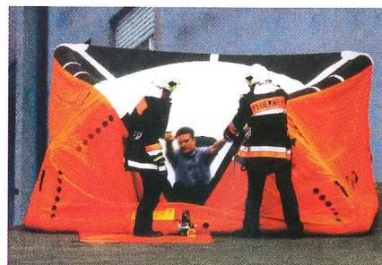
Slika 6.11. Zračni uskočni jastuk:
