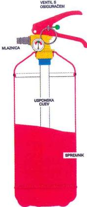
Slika 7.2 P1,2,3 - pod stalnim tlakom
