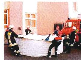
Slika 6.10 Zračna uskočnica
