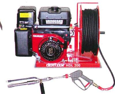
Slika 8.6 Visokotlačna klipna pumpa s vtimom i mlaznicom
